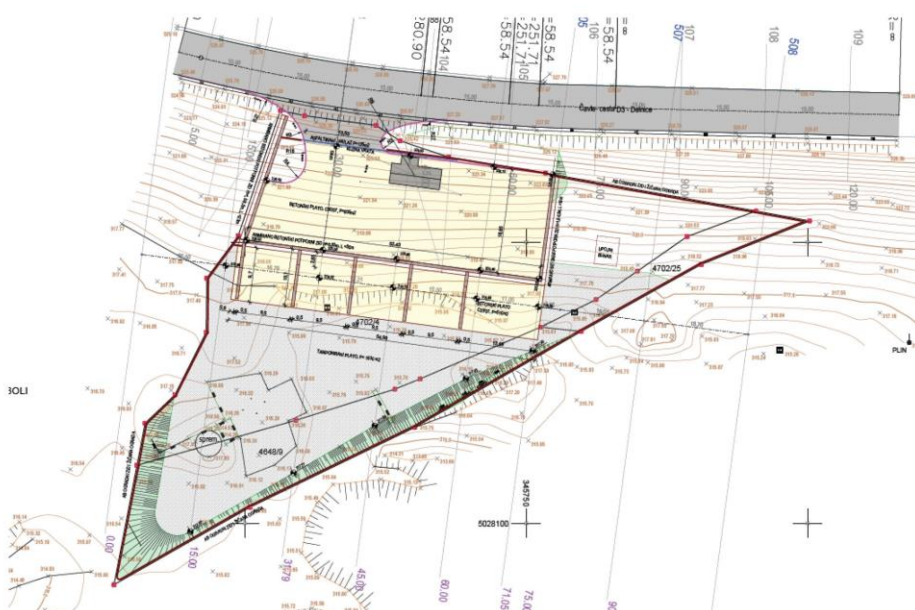
Slika 2 - situacijski prikaz površine formirane od dva platoa s potpornim zidovima, kazetama i kontejnerom s uredskim, spremišnim i sanitarnim prostorijama na geodetskoj podlozi
